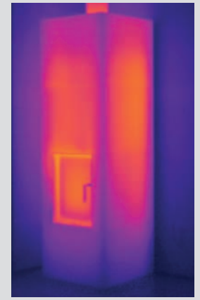
12 uur na verwarming Gemiddelde oppervlaktemperatuur 45 °C
